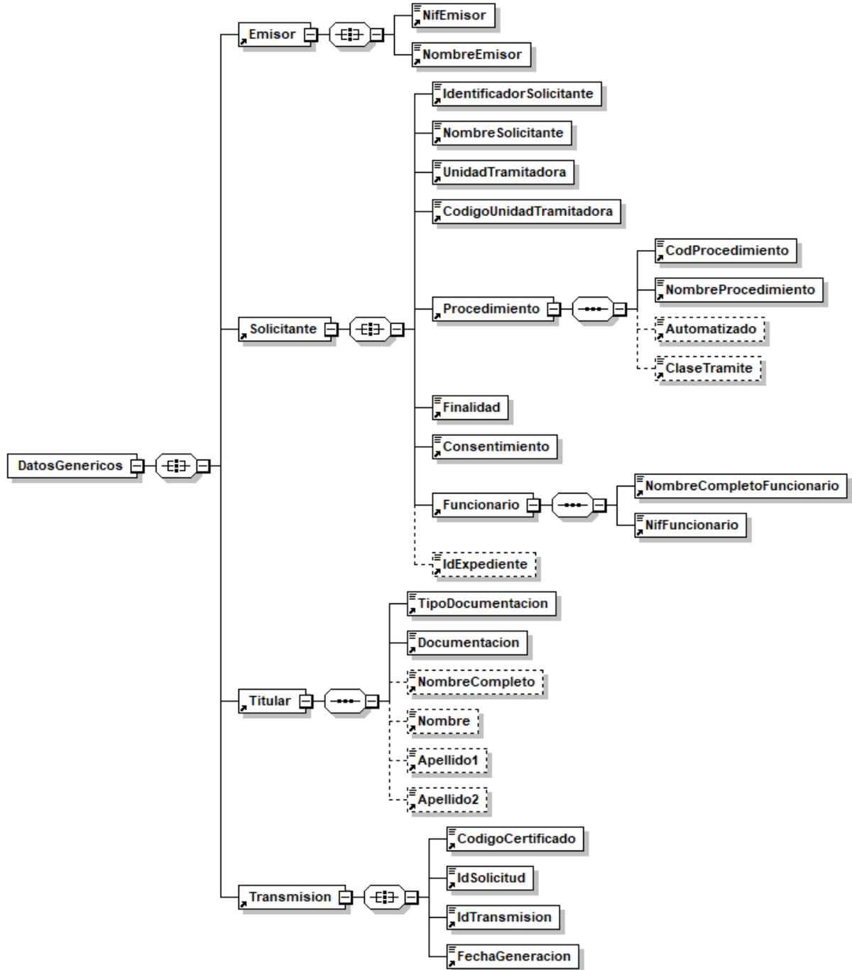
Figura 6.- Diagrama de la rama DatosGenericos del mensaje de respuesta del Servicio
