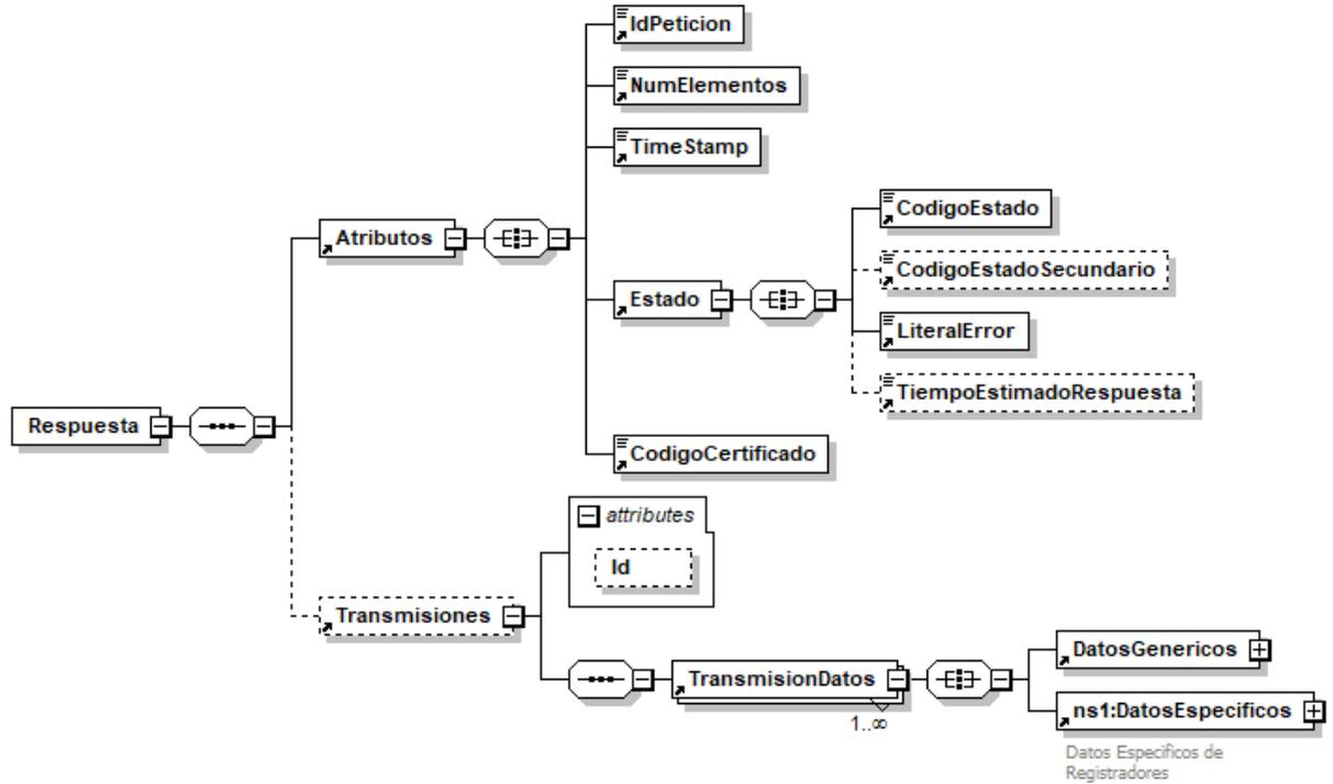
Figura 5.- Diagrama del mensaje de respuesta del Servicio
