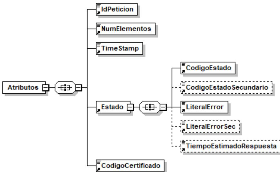
Figura 80.- Diagrama del mensaje SOAP Fault del Servicio
