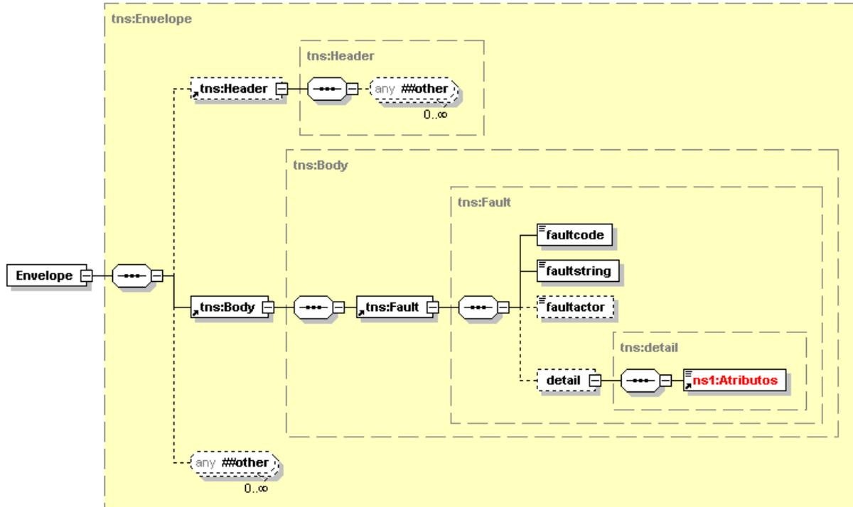
Figura 5. Diagrama del mensaje SOAP Fault del Servicio
