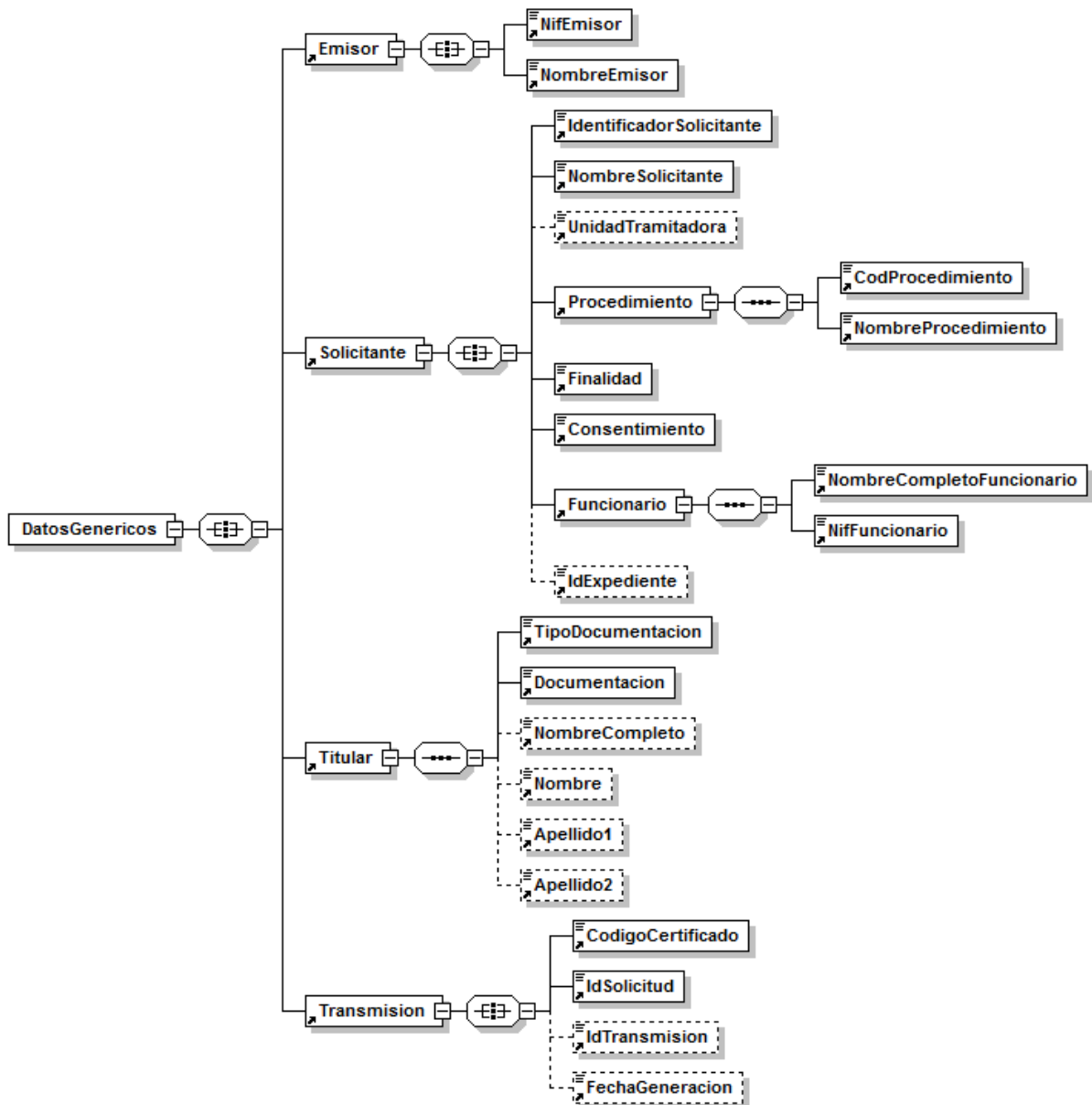
Figura 3. Diagrama de la rama de DatosGenericos del mensaje de petición del Servicio
