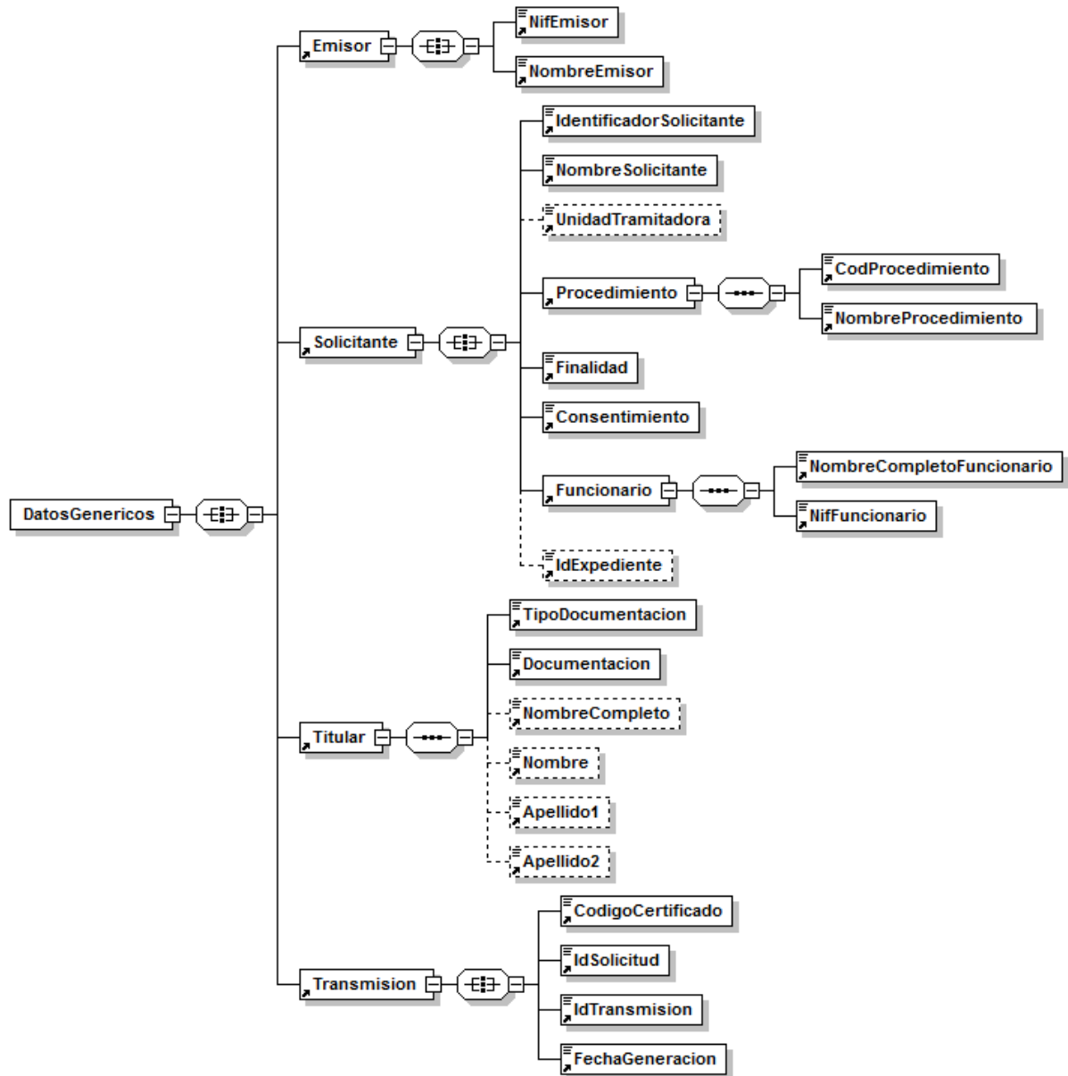
Figura 5. Diagrama de la rama DatosGenericos del mensaje de respuesta del Servicio
